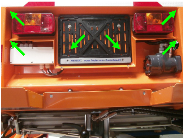
Abb. 7 Lampenträger und Kennzeichenhalter verschraubt
